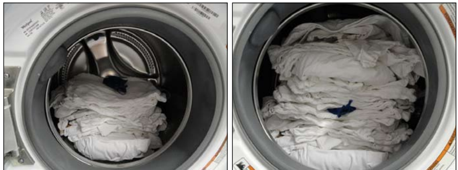
Abb. 2: Die Baumwollsäckchen werden in der Mitte der Ladung platziert, ohne dass sie sich gegenseitig berühren
